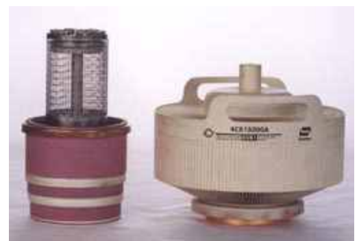
4CX15.000A con el ánodo desmontado
